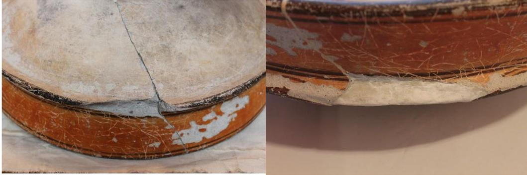
Figura 6.70. Plato HM.LT.01.00.02.03 después de unión de fragmentos. Se observa el área faltante de la pestaña. Foto: M. Colín.
