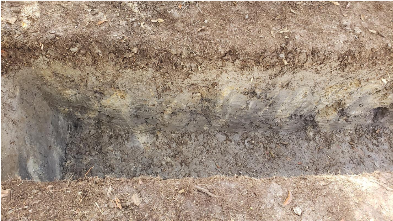
Figura 1.20. Perfil de la excavación en campos elevados (Tasistal) mostrando suelos arcillosos y perturbación debida al ciclo de humedad y secamiento periódico típico de los suelos de los bajos con inundación intermitente.
